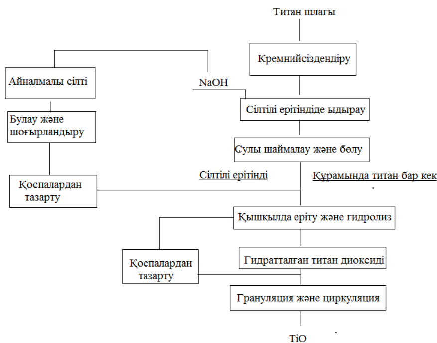
3 Сурет – Таза титан диоксидін алудың технологиялық схемасы
